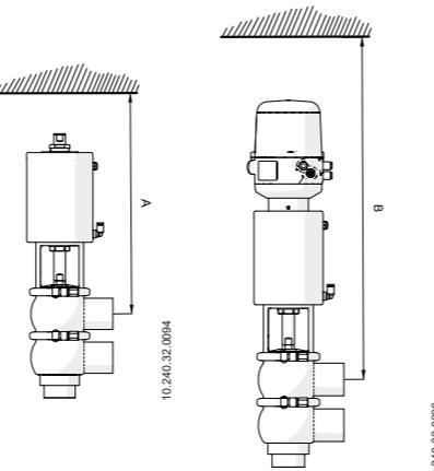
Dans le cas des vannes INNOVA K, il est conseillé que l'union d'un des corps soit effectuée par raccord pour faciliter le démontage de la vanne.
